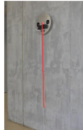
図2 真空チャンバー内蔵ブロワー吸着型壁面移動ロボットの試作機と壁面移動の軌跡（赤線）
