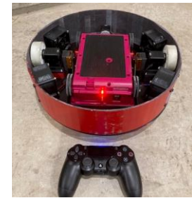
図2 真空チャンバー内蔵ブロワー吸着型壁面移動ロボットの試作機と壁面移動の軌跡（赤線）
