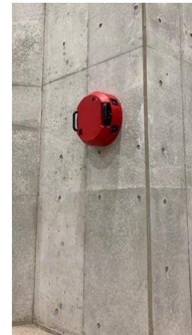
図3 新たに開発した電磁波レーダ搭載ブロワー吸着型壁面移動ロボット
