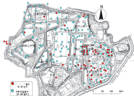
図-5 常時微動探査の実施地点
