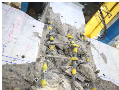
写真2 鉄筋コンクリート外周柱梁接合部の軸崩壊
