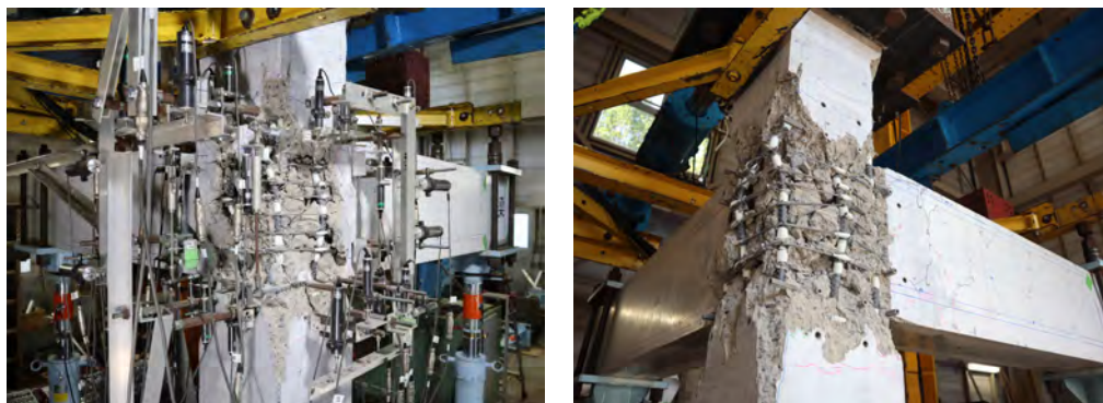
写真3 鉄筋コンクリート隅柱梁接合部の軸崩壊（試験体 F5）
