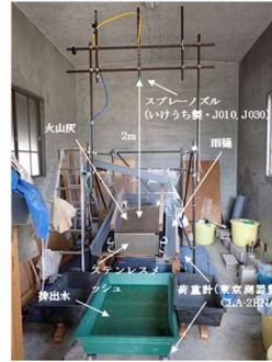
写真 3-1 実験装置の構成
