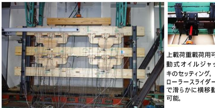
上載荷重載荷用可動式オイルジャッキのセッティング。ローラー滑り台で滑らかに横移動可能。
