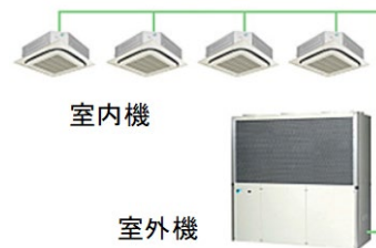
図1 VRF エアコン
