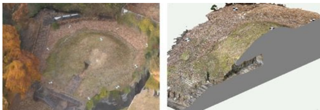
図 1 左: SfM により作成した中山荘園古墳の 3次元モデル 右: LiDAR 測量により作成した同古墳の墳丘と横穴式石室の 3次元モデル(切断面表示)
