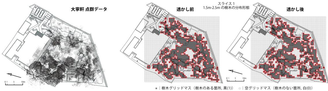
図 2 大寧軒庭園の点群データと、透かし剪定前後の樹木量の変化
