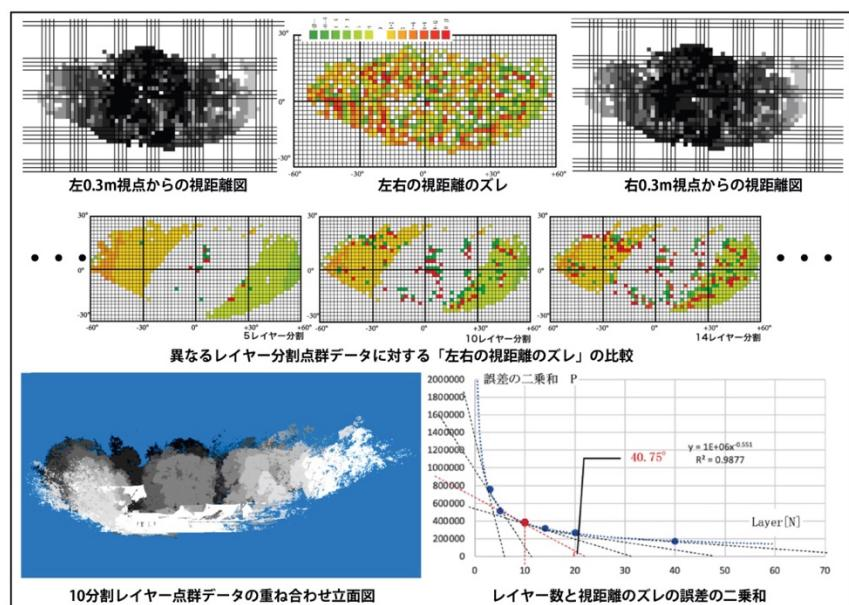
図6 レイヤー分割した点群の植栽空間断面図表示法の分析
