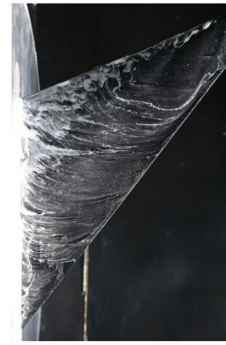
第6図 風洞試験で得た \Lambda = -20^\circ の表面流線
