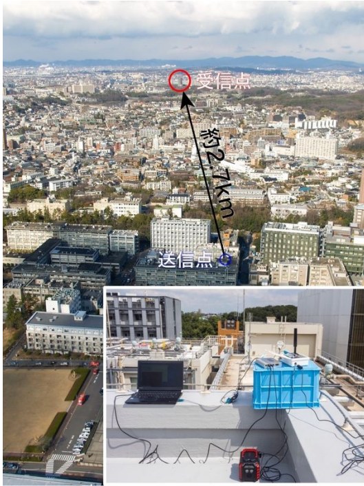
図2 3回目の陸上実験。送受信点の位置関係と送信側（名古屋大学）の様子を示す。
