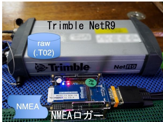
図6 海上での移動体の試験の様子。GNSS 受信機 (Trimble NetR9) には生データが保存され、これを用いて RTKLib による後処理 PPP 解析を行い、これをリファレンスとした。CenterPoint RTX による測位結果は NMEA 形式で出力され、自作の NMEA ロガーに保存される。
