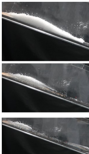
図1 盛土構造物崩壊時の土石流発生 (RIM 法)
