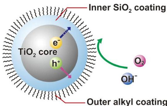
図3. ダブルシェル型TiO<sub>2</sub>光触媒ナノ粒子
