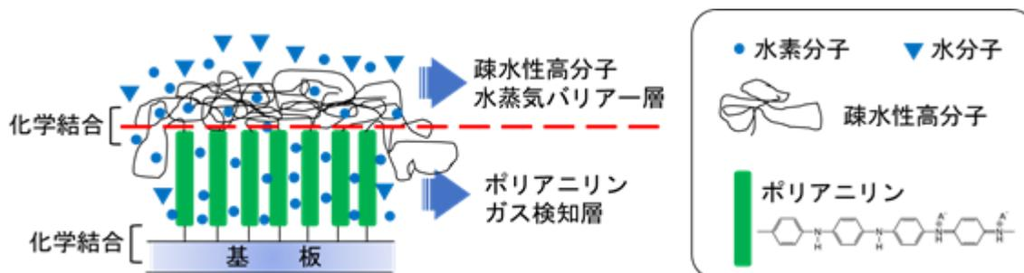
図1 基板に結合した二層構造を有するフレキシブル室温作動型水素センサー
