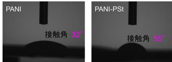
図7 PS<sub>t</sub>層を付与する前後の検知膜の水接触角：PANI(付与前)、PANI-PS<sub>t</sub>(付与後)
