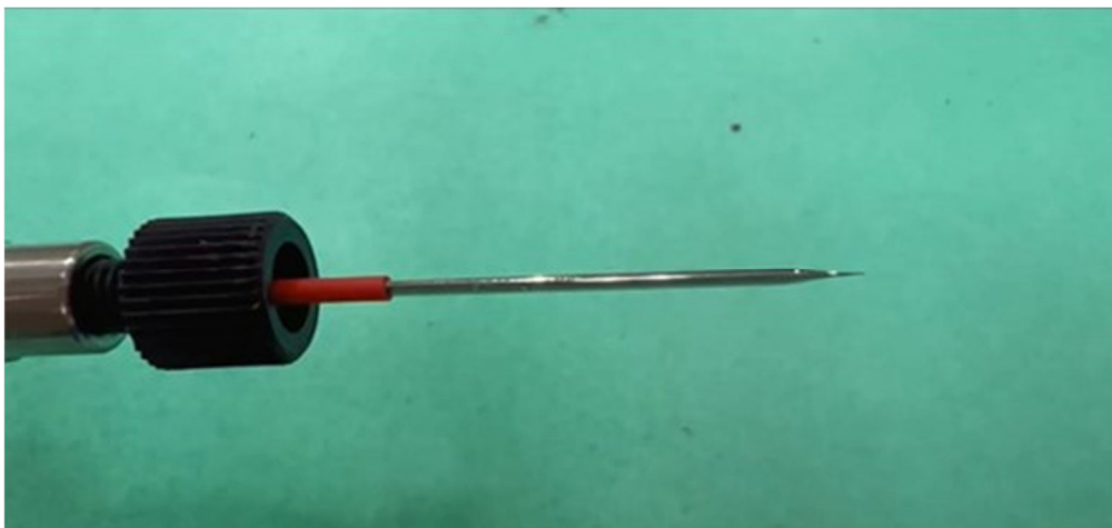
図 2 本研究で開発した V-ESI チップ(内径 : 40 \mu m 外径 : 1 mm, (株)Humanix Cellomics)
