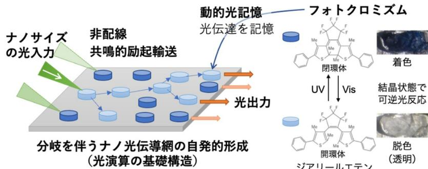
図1 フォトクロミック微結晶2次元アレイ構造とナノ光入出力相關計測系
