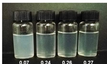
図 5 APTMS で表面変性した NFBC (数値は置換度) の THF 分散液 (濃度 0.5 w/v%)
