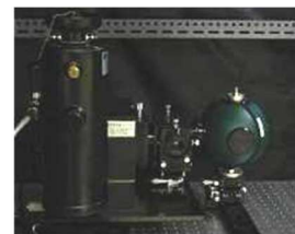
発光反応溶液の光子数を測定するための積分球式分光測定装置
