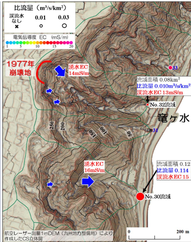
図6 竜ヶ水付近の流域における湧水調査
