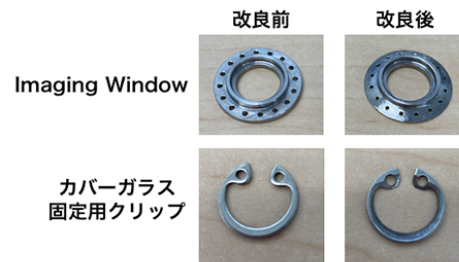
図 2) 作製・改良した Imaging Window とカバーガラス固定用クリップ
