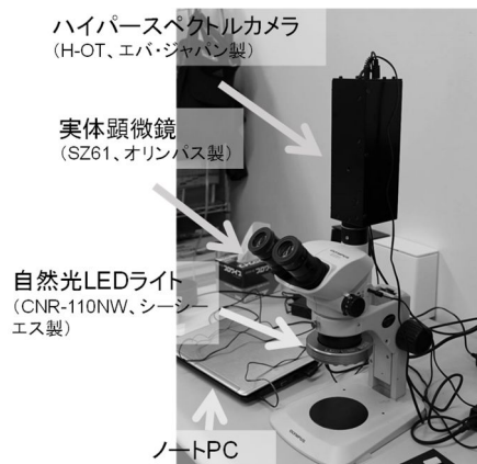
図2. ハイパースペクトル画像撮影システム。
