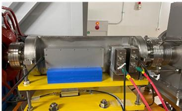
図8 ビーム高速遮断セクションのビームダンプ部写真。ビームは真空窓から大気中に取り出され、電離箱 (図中右) を通過した後にファラデーカップ (図中左) で収集される。
