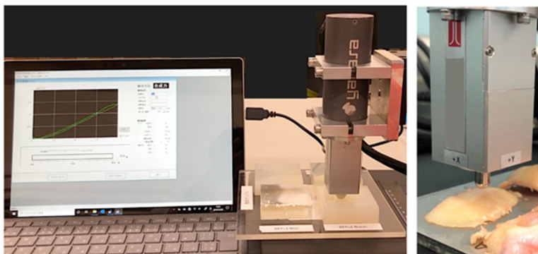
図 1 新規開発弾力測定器
