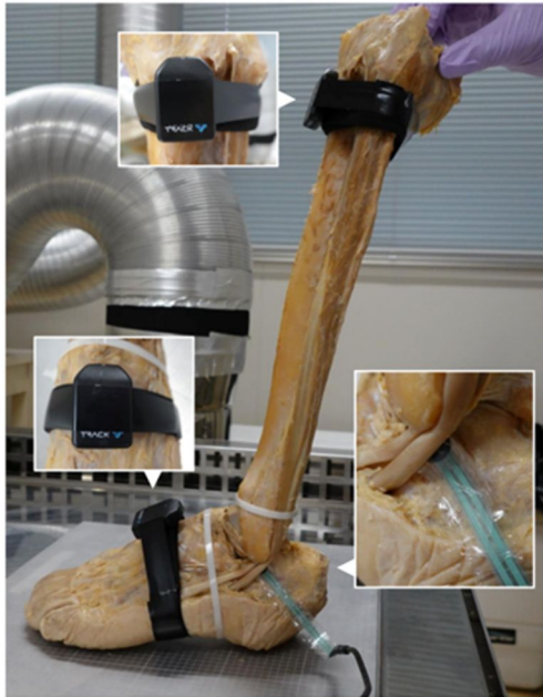
図2 感圧センサおよび慣性センサの設置方法
