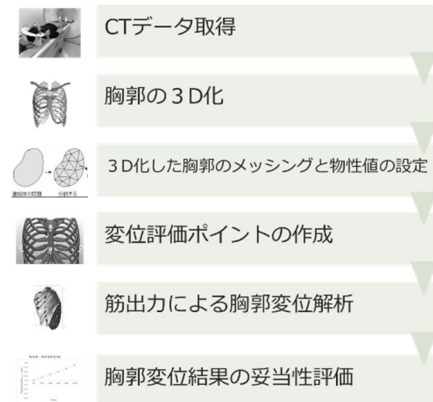
図 1. イメージベースの有限要素解析のフロー
