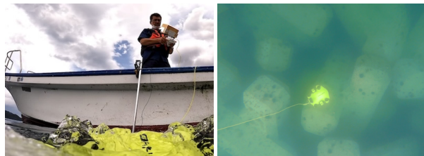
図 2 ROV を用いた海底調査の様子
