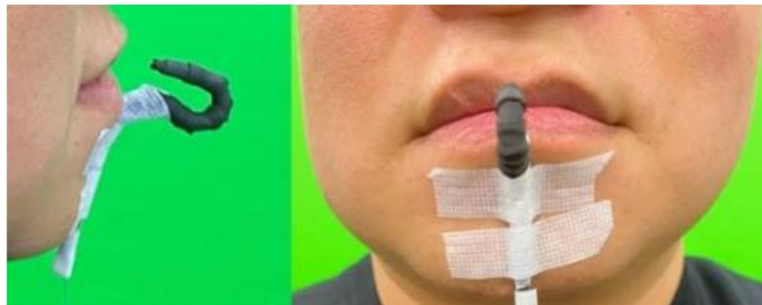
(b) 熱電対センサの固定方法
