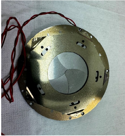
図4：汎用のメカニカルシャッターをチタン薄板のシャッターブレードに改良して製作した可変ターゲットの外観。
