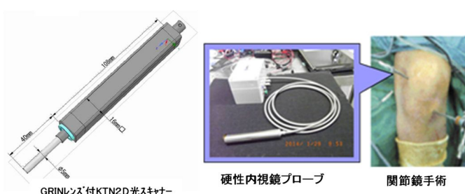
図2 硬性内視鏡プローブと関節内視鏡のイメージ
