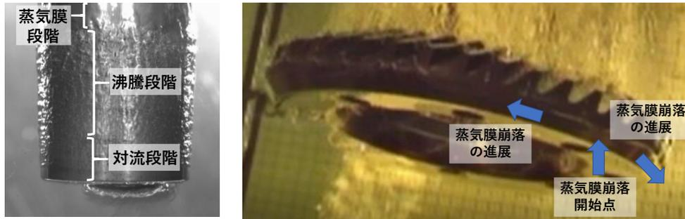
図 1. 円筒における蒸気膜崩落の様子 図 2. 円環歯車における蒸気膜崩落の進展
