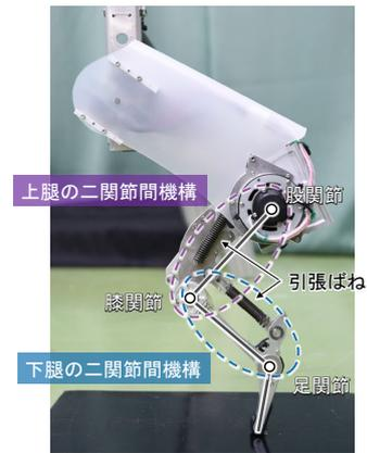
図1 二関節間筋腱複合体機構を備えた一脚ロボット
