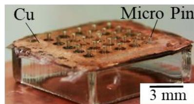
図4 作製したピン層および Cu フレーム層/PDMS バイアスばね層
