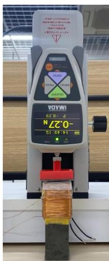
(a) 電磁力計測の実験環境
