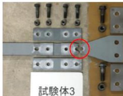
図 17 当て板実験の破断状況
