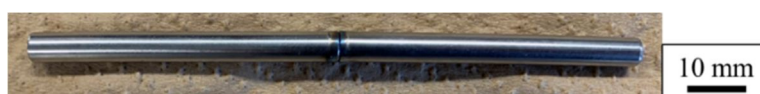
図 2 304 ステンレス鋼同士の通電拡散接合継手の外観写真。接合部における変形が少なく、低変形・短時間での接合が達成された。
