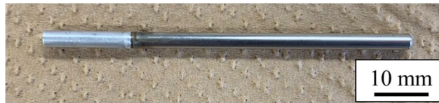
図4 304 ステンレス鋼と5052 アルミニウム合金の通電拡散接合継手の外観写真．異種金属接合においても低変形な継手の作製に成功した．
