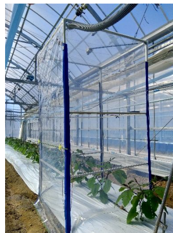
図2 開放型チャンバー法による個体群光合成速度の計測。
