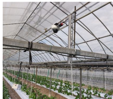
図 3 定点カメラによる葉面積指数 (LAI) の推定。
