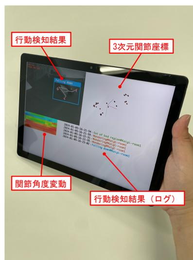
図 6 検知結果表示の一例
