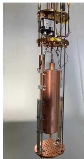
図 3 : 冷凍機インサート部にマイクロ波共振空洞を導入した様子
