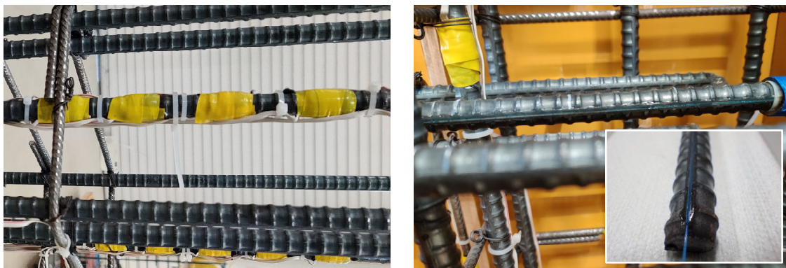
図 4 ひずみセンサーの設置 (左：電気抵抗式，右：光ファイバー式)
