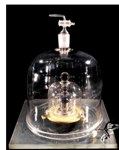
図1 フランス・パリ郊外の国際度量衡局で管理されている国際キログラム
