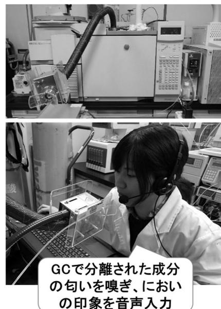
図 3-2 ヒトの嗅覚をもちいて検出する匂い嗅ぎガスクロマトグラフィー（GC-O）による分析の様子。GC-MS では検出できない微量な匂い成分の検出可能である。
