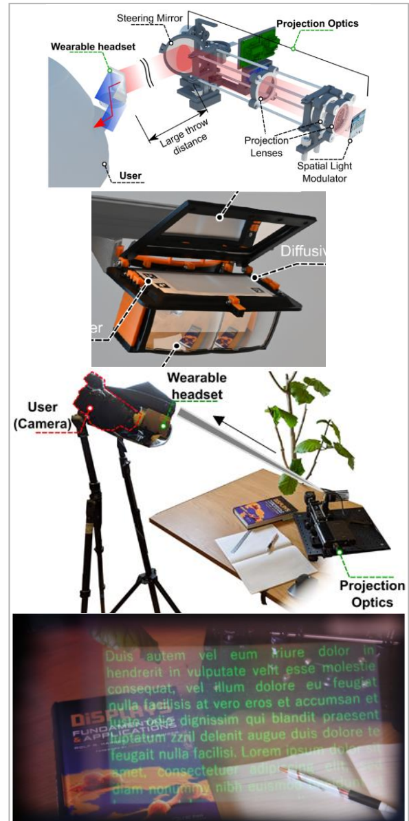
図3：原理検証のための、SP1台と受光メガネにおけるBeaming Displayの原理検証。（上）光学系模式図。（中上）試作中のパッシブな眼鏡部（重量122g）。（中下）撮影セットアップ。（下）目の位置から見たAR映像（テキストが表示されている）。原理上SPを増やすことで、提示できる映像の時空間解像度を高められる。
