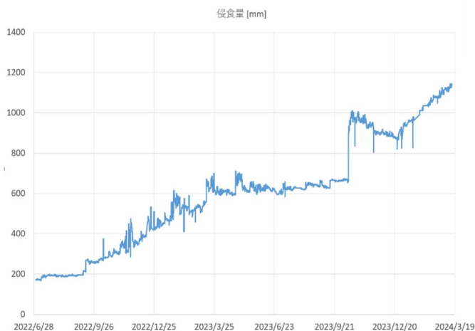
図2: 斜面の侵食量の時間変化
