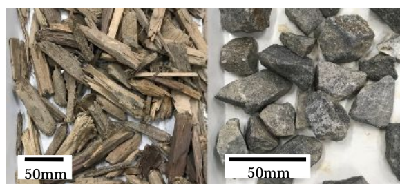
写真-1 使用した木片(左)と碎石(右)の外観
