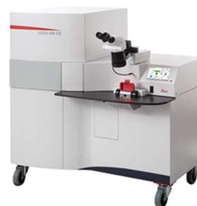
図3. 加圧凍結装置
