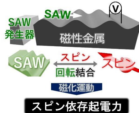
図 3 表面弾性波(SAW)を用いた磁化運動のスピン依存起電力変換
