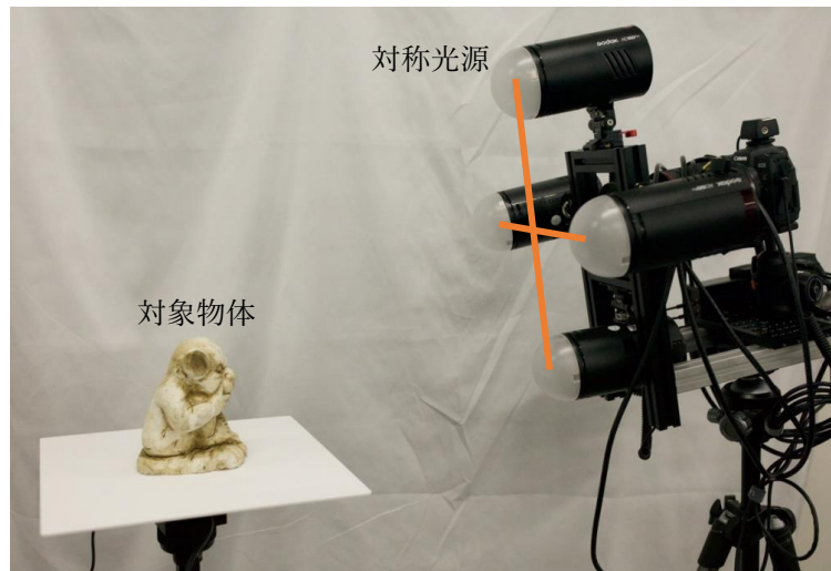
図 2 対称光源による照度差ステレオ法
