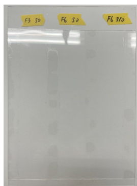
図7 作製した水環境サンプル用大型検鏡デバイスと模式図（左：作製したデバイス、右：模式図 水環境サンプルをアクリル板の隙間に滴下すると毛細管現象により隙間に平面に広がり光学スキャナーでの観察が容易にできる。）
