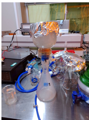
図6 実験時の様子と薬品処理結果（左：減圧ろ過時の作業の様子、中：薬品処理後の水環境サンプルを含む溶液、右：薬品処理後の水環境サンプルの電子顕微鏡写真）
