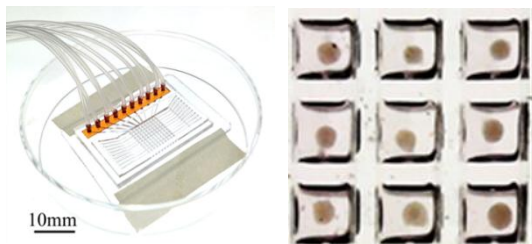
胚様体形成特化型プラットフォーム(左)と、形成した幹細胞胚葉体群(右)
