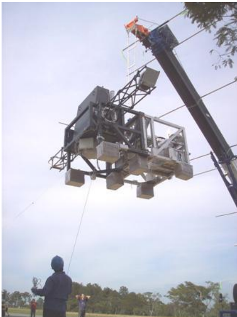
図1 科学観測用大気球に搭載する宇宙遠赤外線干渉計 FITE の打上げ前試験の様子
