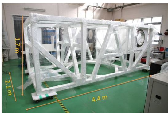
図4 . CFRP 製主構造体。白色遮熱塗装済。
